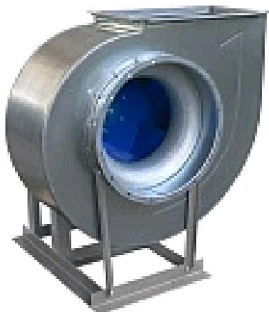
Радиальные вентиляторы представляют собой расположенное в спиральном кожухе рабочее колесо, при вращении которого воздух, попадающий в каналы между его лопатками, движется в радиальном направлении к периферии колеса, сжимается и под действием центробежной силы отбрасывается в спиральный кожух и далее направляется в выходное отверстие.
