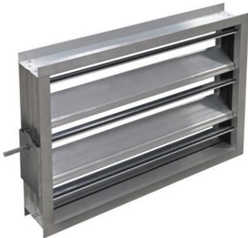
Воздушные алюминиевые клапаны ВК, ВКм и воздушные алюминиевые клапаны с подогревом ВКп предназначены для регулирования расхода приточного, рециркуляционного или вытяжного воздуха в системах вентиляции и кондиционирования, а также для герметизации внутреннего объема вентиляционных сетей, рабочее давление которых не превышает 1000 Па.
